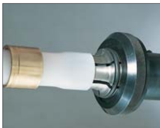
Laajenna PEX-putken pää.
