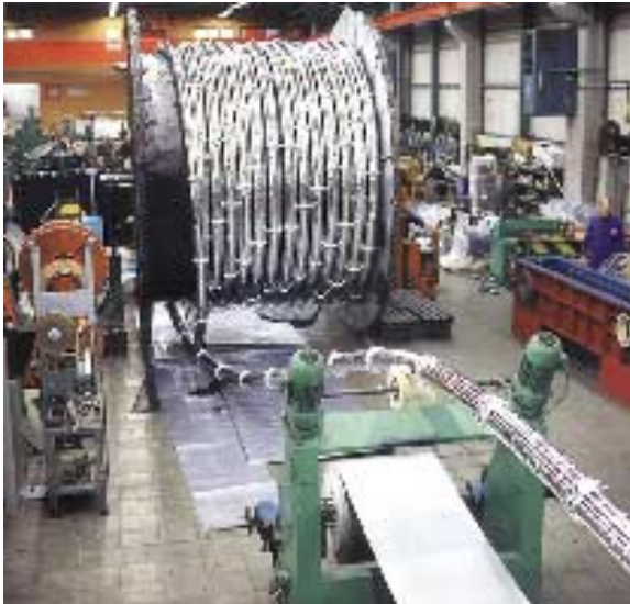
Fertigung von vakuumisolierten CRYOFLEX®-Leitungen Production of vacuum insulated CRYOFLEX® Transfer Lines
