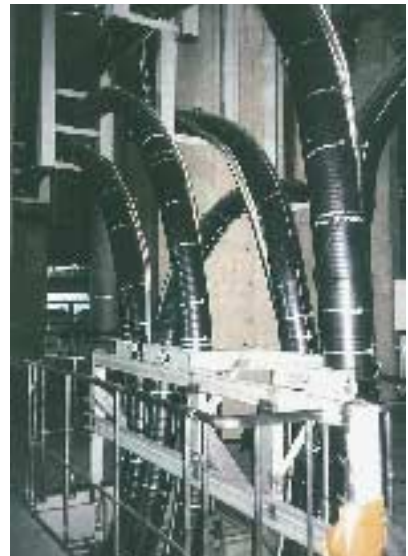
Supraleitendes LTS-Kabel für die Fusionsforschung Superconducting LTS cable for Fusion Science
