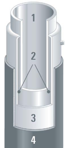
Aufbau des BRUGG-STAMANT®- Sicherheitsrohres
