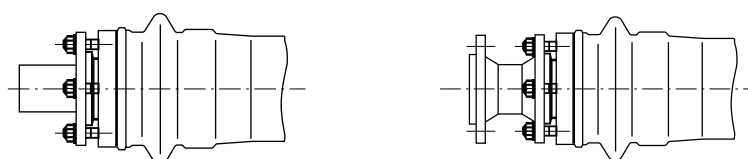
Abb. 2: Ausführungsarten der Anschlussverbindung
