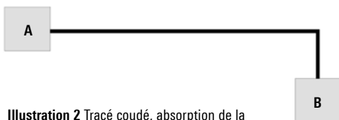
Illustration 2 Tracé coudé, absorption de la dilatation à l'aide d'un changement naturel de direction dans le coude en L et l'immeuble A.
