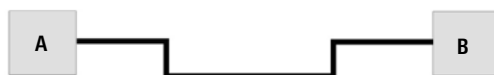
Illustration 3 Tracé droit entre deux immeubles avec absorption de la dilatation dans le cadre du tracé à l'aide de deux coudes en Z.
