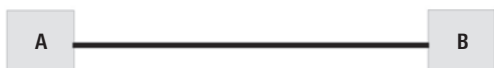
Illustration 1 Tracé droit entre deux immeubles; la dilatation des tubes de chauffage à distance doit être absorbée dans l'immeuble A ou B.
