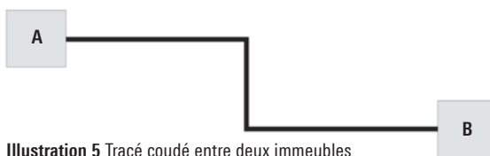
Illustration 5 Tracé coudé entre deux immeubles avec absorption de la dilatation dans le cadre du tracé à l'aide d'un coude en Z.
